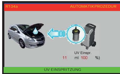
Bei Vervollständigung wird das System mit dem Einfüllen der voreingestellten Kühlmittelmenge fortfahren.
