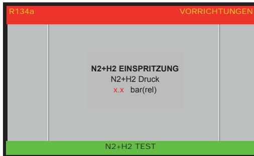
Die Mixtur (N<sub>2</sub>+N<sub>2</sub>) wird in die Klimaanlage eingespritzt, der Test Startet sobald der Druck stabil ist:
