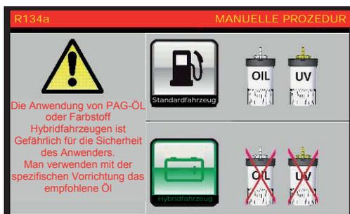
STANDARD FAHRZEUG oder HYBRIDFAHRZEUGE wählen, gemäß der Auswahl, wird eine der folgenden Anzeigen erscheinen:
