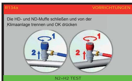
Die HD- und die ND-Muffen aufschrauben, von der Klimaanlage abtrennen und OK drücken um den MIXTURE TEST (N<sub>2</sub>+H<sub>2</sub>) abzuschließen.
