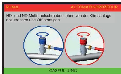
HD- und ND-Anschluss aufschrauben, ohne diese vom Luftkonditionierer abzuschließen und OK drücken, um fortzufahren:
