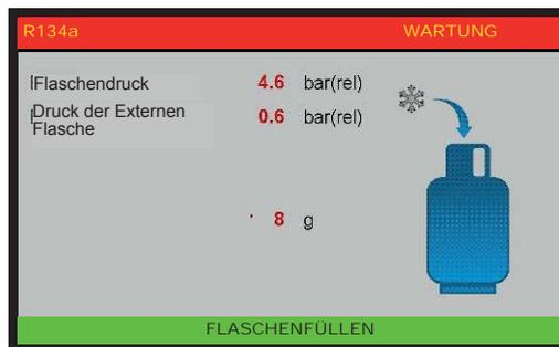
Die Maschine wird nun die Maschinenflasche mit der voreingestellten Menge ~ 500g füllen. Ist die Menge minus 500 Gramm erreicht, stoppt die Maschine und folgende Anzeige erscheint:
