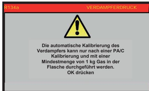
**ACHTUNG:** Automatische Verdampferdruckkalibrierung kann nur nach einer Klimaanlage-Druckkalibrierung und mit mindestens 1 kg Gas in der Flasche durchgeführt werden.
