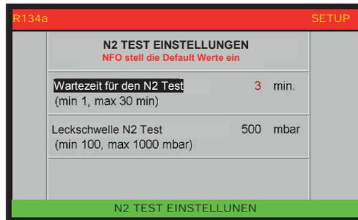
Jeder Wert kann gemäß den Werten geändert werden, die in Klammern stehen.
