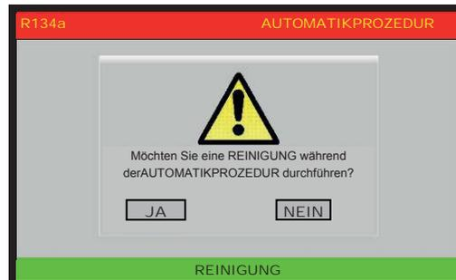
Man wähle JA um eine REINIGUNG während der AUTOMATIKPROZEDUR durchzuführen (man beziehe sich auf das Anwenderhandbuch Desinfektionsmittel [MANU040.IGN]), oder man betätige NEIN, um dies zu überspringen, dann erscheint folgende Anzeige:
