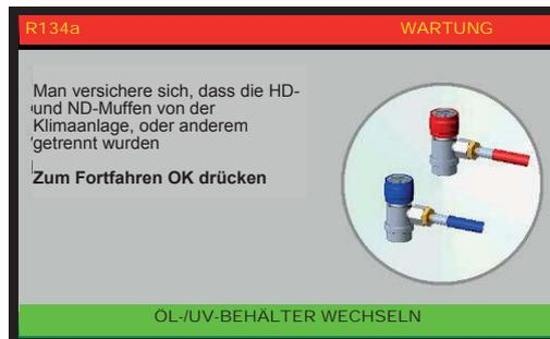
Man versichere sich, dass die HD- und ND-Muffen von der Klimaanlage oder sonst getrennt sind, dann betätige man OK:
