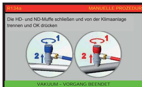
HD und ND Muffe schließen und von der Klimaanlage trennen, dann OK drücken, um zu dem HAUPTMENÜ zurückzukehren, VAKUUM ABLAUF ist nun erfolgreich abgeschlossen.
