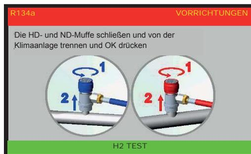
Die HD- und die ND-Muffen aufschrauben, von der Klimaanlage abtrennen und OK drücken um den N2 TEST abzuschließen.
