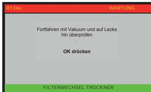
14) OK drücken zum Fortsetzen mit Vakuumkontrolle:
