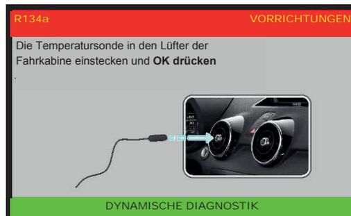
Den Temperaturfühler in den Lüfter im Wageninneren einführen und daraufhin OK drücken:
