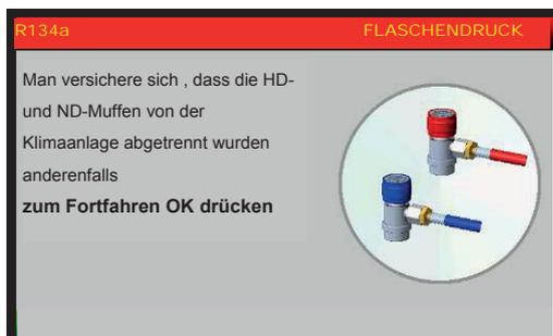
Man versichere sich, dass die HD- und ND-Muffen von der Klimaanlage oder sonst getrennt sind, dann betätige man OK, um fortzufahren:
