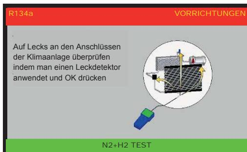
Man überprüfen, ob Lecks am Anschluss der Klimaanlage vorhanden sind, indem man einen Leck-Detektor verwendet; daraufhin erscheint folgende Anzeige. Die Maschine lässt die Mixtur ab:
