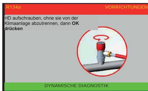
HD-Muffe aufschrauben, ohne von der Klimaanlage abzutrennen und OK drücken:
