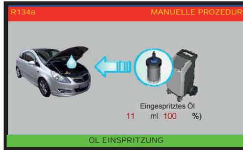
Öl wird eingespritzt und daraufhin wird, wenn es vorher eingestellt wurde, UV eingespritzt.
