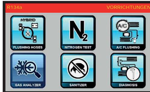
Dann wähle man GASANALYSATOR; ist ein Gasanalysator installiert, wird die Maschine, vor dem Beginn der Rückgewinnung, die Reinheit des Kühlgases im Luftkonditionierer testen (mit Bezug auf das Anwenderhandbuch Gasanalysator [MANU043.ANL]).
