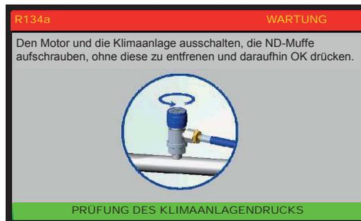
Den Motor und die Klimaanlage ausschalten, ND Muffe abschrauben ohne diese zu trennen, dann OK drücken:
