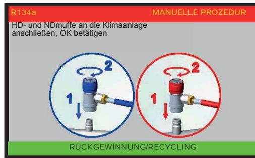
Man schließe die Muffe an die Klimaanlage und öffne diese, danach betätige man OK, man betätige ZURÜCK um zurückzukehren.
