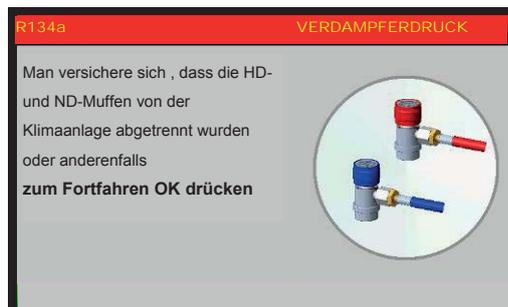
Man versichere sich, dass die HD- und ND-Muffen von der Klimaanlage, oder sonst, getrennt sind, dann betätigt man OK, um fortzufahren:
