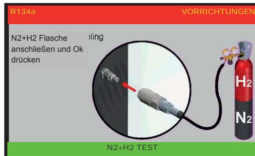
Die Mixture (N<sub>2</sub>+H<sub>2</sub>) Flasche anschließen und OK drücken:
