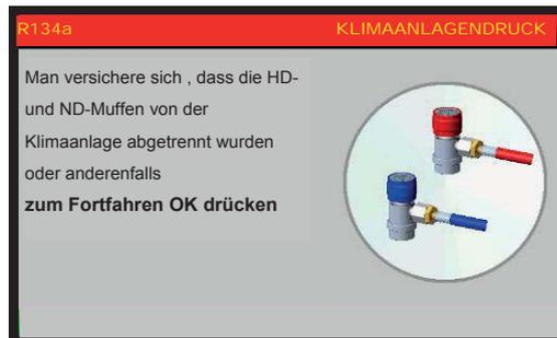
Sicherstellen, dass HD und ND Muffen von der Klimaanlage getrennt sind und OK drücken:
