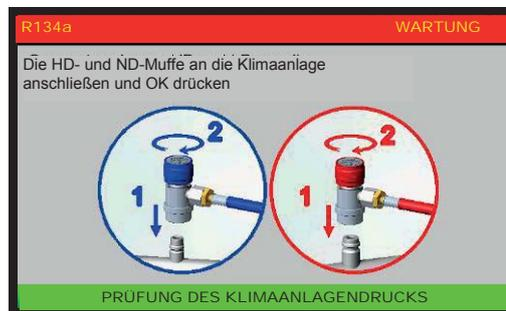
Die an die Klimaanlage angeschlossene Muffe verbinden und öffnen, dann OK drücken, ZURÜCK drücken, um zurückzukehren; die folgende Anzeige erscheint:
