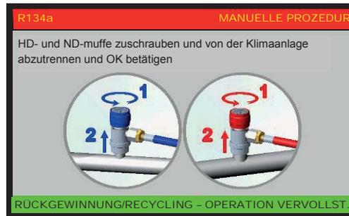
Den HD- und die ND-Anschluss aufschrauben und von der Klimaanlage abtrennen und OK drücken um die RÜCKGEWINNUNGS-/RECYCLINGPROZEDUR abzuschließen.
