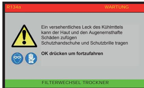
Kältemittelleckage können schwere Schäden an Haut und Augen verursachen, Schutzhandschuhe und Schutzbrille tragen. OK drücken zum Fortsetzen:
