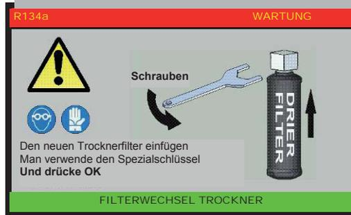
12) Den neuen Filter des Trockners einsetzen, dazu verwende man den Spezialschlüssel (Bez. Abb. 19),
