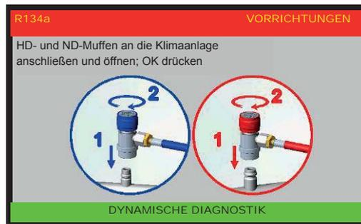
Die HD- und ND-Muffen an die Klimaanlage anschließen, daraufhin OK drücken; folgende Anzeige erscheint:
