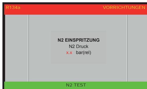
Das Nitrogen wird in die Klimaanlage eingespritzt, der Test Startet sobald der Druck stabil ist:
