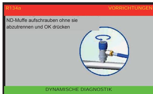
Die Niederdruckmuffe aufschrauben, ohne diese abzutrennen und OK drücken:
