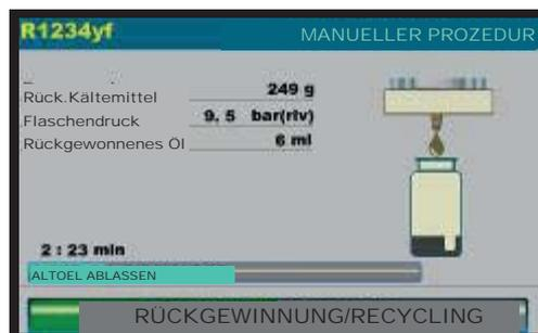
Die Maschine überprüft ob Luft in der Flasche ist und, wenn notwendig, das nicht-kondensierbare Gas abführen. Die Maschine lässt automatisch nicht kondensierbares Gas ab.
