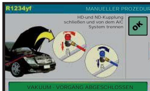
HD und ND Kupplung schließen und von A/C System trennen, dann OK drücken, um zu dem HAUPTMENÜ zurückzukehren, VAKUUM PROZEDUR ist nun erfolgreich abgeschlossen.
