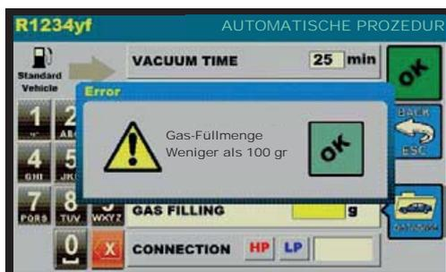
Gasbefüllung geringer als 100 Gramm ist nicht erlaubt, OK drücken und dann eine größere Menge an Gasbefüllung eingeben.
