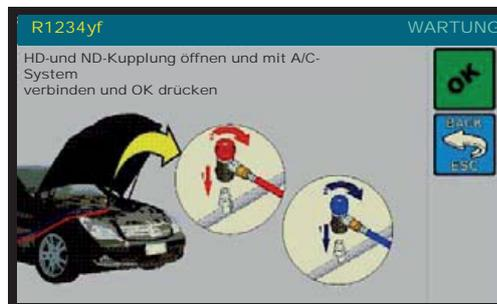
HD und ND Kupplung an das A/C System anschließen und öffnen, dann OK drücken um fortzufahren, die folgende Anzeige erscheint::
