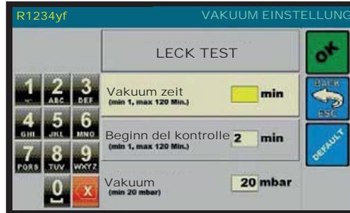
Jeder Wert kann geändert werden, innerhalb der Werte die in Klammern angezeigt werden.
