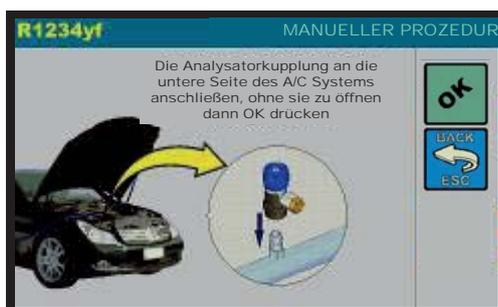
Die ND Kupplung des externen Analysators an das A/C System anschließen, dann OK drücken, ZURÜCK drücken, um zurück zu gehen
