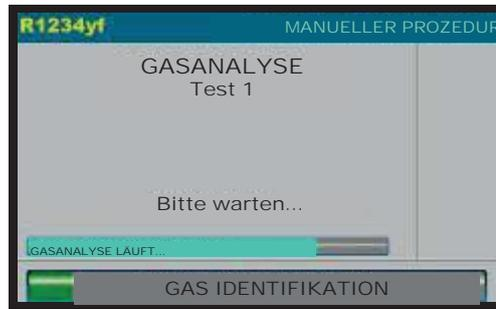
Falls das Kältemittel in dem A/C System nicht die geforderten Reinheitsstandards erfüllt, führt die Maschine einen zweiten und dritten Test durch. Wenn alle drei Tests fehlschlagen:
