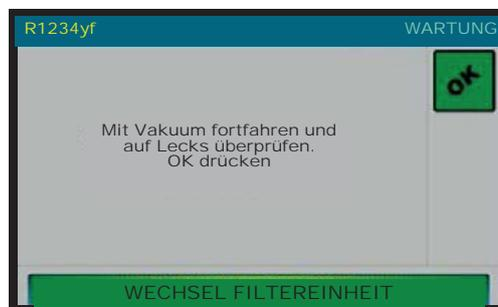
16) OK drücken zum Fortsetzen mit Vakuumkontrolle:
