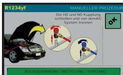
Die HD und ND Kupplung abschrauben und vom A/C System trennen, dann OK drücken um RÜCKGEWINNUNG / RECYCLING VORGANG zu beenden.
