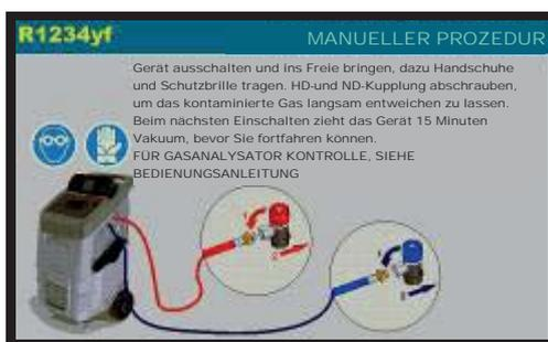
Gerät ausschalten und ins Freie bringen, dazu Handschuhe und Schutzbrille tragen. HD-und ND-Kupplung abschrauben, um das kontaminierte Gas langsam entweichen zu lassen.
