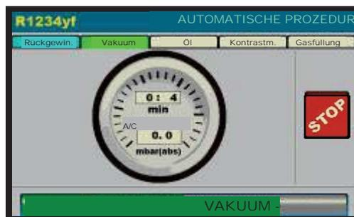
(WARNUNG! Wenn die Vakuumzeit < 15 Minuten ist, wird dieser Test vertrauenswürdig). Wenn Lecks gefunden werden, stoppt die Maschine automatisch und der A/C SYSTEMLECK Alarm erscheint.
