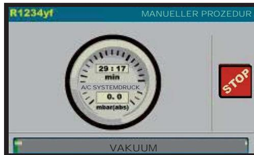
Wenn die Testzeit erreicht ist, testet die Maschine auf Lecks im A/C System :
