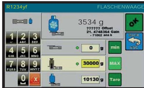
Das Bezugsgewicht entfernen, dann das richtige Ablesen der Waage überprüfen und verschiedene Bezugsgewichte dazugeben und entfernen.
