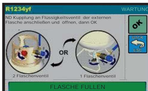
ND-Kupplung an Flüssigkeitsventil der externen Flasche anschließen und öffnen, dann OK drücken.
