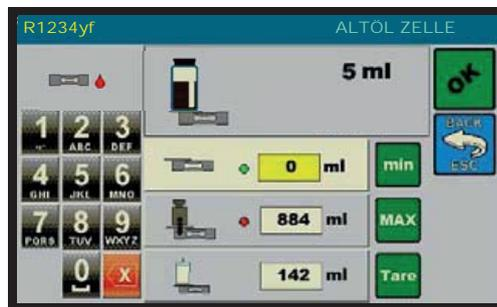
Den ALTÖL Behälter mit einer bekannten Menge an Öl füllen (100 bis 250 cc gemessen auf den Behältermessanzeigen). Ersetzen Sie den Behälter in seine Herberge. Den Textkasten Max wählen, mit den Tasten 0 bis 9 den Wert der Menge eingeben; die MAX Taste drücken (der entsprechende Lichtpunkt wird grün werden):
