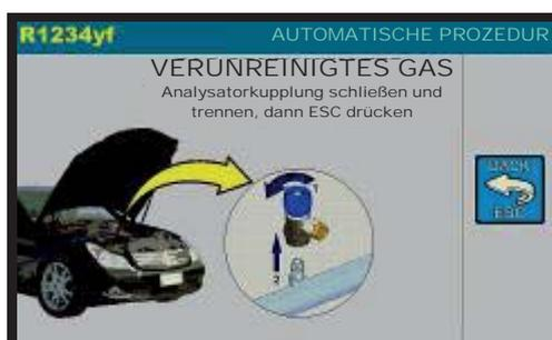
Analysatorkupplung schließen und trennen, dann ESC drücken
