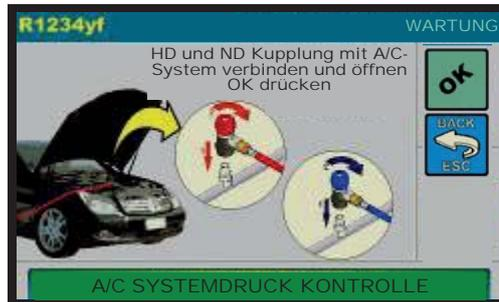
Die an das A/C System angeschlossene Kupplung verbinden und öffnen, dann OK drücken, ZURÜCK drücken, um zurückzukehren; die folgende Anzeige erscheint:
