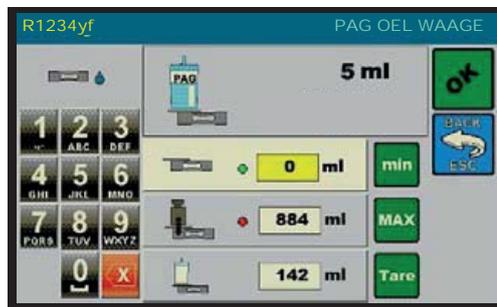
Den neuen Öl Behälter mit einer bekannten Menge an neuem Öl füllen (100 bis 250 cc gemessen auf den Behältermessanzeigen). Ersetzen Sie den Behälter in seine Herberge. Den Textkasten Max wählen, mit den Tasten 0 bis 9 den Wert der Menge eingeben; die MAX Taste drücken (der entsprechende Lichtpunkt wird grün werden):
