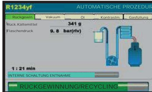
Wenn die Rückgewinnungsphase beendet ist, läuft die Maschine automatisch die Vakuumphase für die voreingestellte Zeit:
