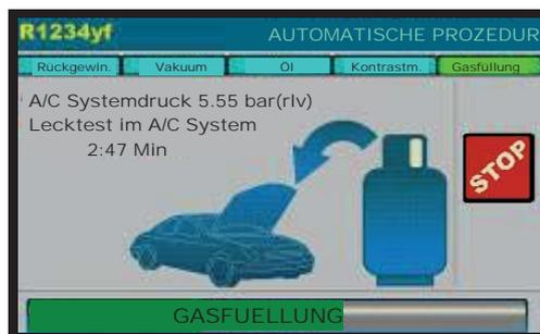
Wenn Lecks gefunden werden, gibt die Maschine eine akustische Alarmmeldung, andernfalls fährt die Maschine mit der Behüllung mit der voreingestellten Kältemittelmenge fort.
