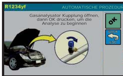
Gasanalysator Kupplung öffnen, dann OK drücken, um die Analyse zu beginnen.
