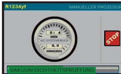
(WARNUNG! Wenn die Vakuumentzeit weniger als die 15 min, wird dieser Test vertrauenswürdig). Wenn Lecks gefunden werden, stoppt die Maschine automatisch und der A/C SYSTEMLECK Alarm erscheint.
