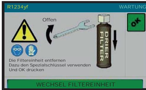
11) Die Filtereinheit mit dem Spezialschlüssel entfernen (siehe Abb. 24)
