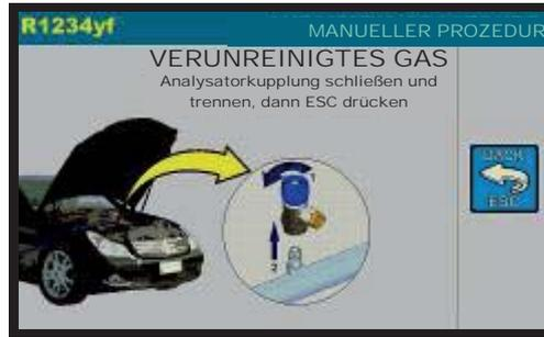
Analysatorkupplung schließen und trennen, dann ESC drücken
