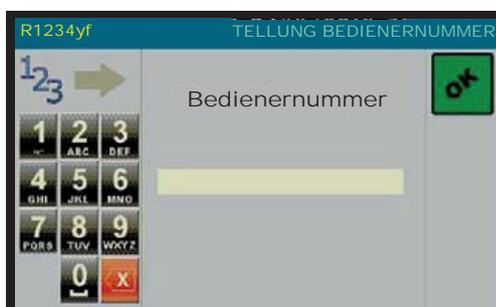
Es kann ein alphanumerischer Code von 10 Zeichen eingegeben werden, um die Freigabe des Bedieners anzugeben. Diese Nummer wird auf allen Drucken angegeben.
