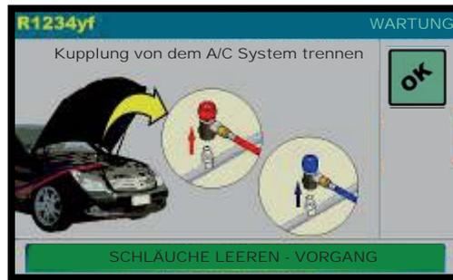
Kupplung von A/C System trennen, OK drücken, um zu dem HAUPTMENÜ zurückzukehren, A/C SYSTEMDRUCK KONTROLLE ist nun erfolgreich abgeschlossen.
