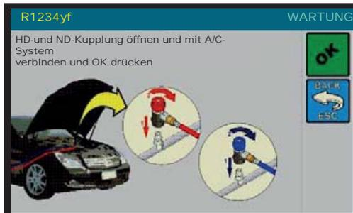
HD und ND Kupplung öffnen und an das A/C System anschließen, dann OK drücken um fortzufahren, die folgende Anzeige erscheint::
