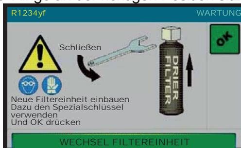
14) Die neue Filtereinheit mit dem Spezialschlüssel einbauen (siehe Abb. 25)
