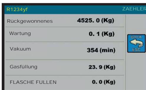
Diese Anzeige zeigt die Gesamtwerte an für: rückgewonnenes Kältemittel, Wartungsalarm ZÄHLER, gesamte Vakuumzeit (Minuten), eingefülltes Gas, rückgewonnenes Gas in der internen Flasche mit der Flaschenbefüllungsfunktion.
