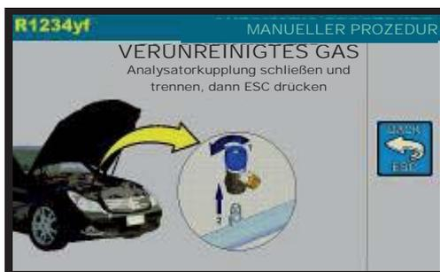
Analysatorkupplung schließen und trennen, dann ESC drücken
