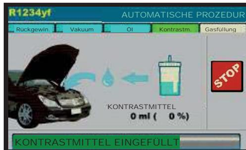
Nach Beendigung, lädt das System 50g Kältemittel und überprüft, ob Lecks in dem A/C System sind:
