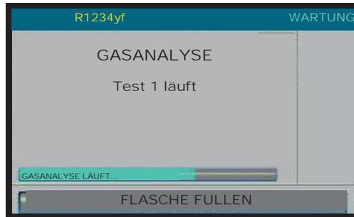
Falls das Kältemittel nicht die geforderten Reinheitsstandards erfüllt, führt die Maschine einen zweiten und dritten Test durch. Wenn alle drei Tests fehlschlagen:
