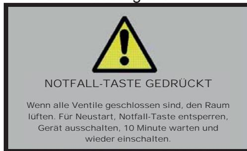
Zum Neustarten der Maschine muss die Notfall-Taste entsperrt werden, Gerät ausschalten.
