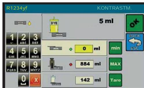
Den KONTRASTM. Behälter mit einer bekannten Menge an KONTRASTM. füllen (100 bis 250 cc gemessen an den Behältermessanzeigen). Ersetzen Sie den Behälter in seine Herberge. Den Textkasten Max wählen, mit den Tasten 0 bis 9 den Wert der Menge eingeben; die MAX Taste drücken (der entsprechende Lichtpunkt wird grün werden):
