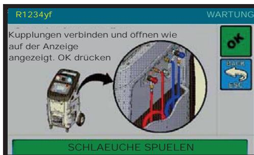
Die HD und ND Kupplungen an die entsprechenden Befestigungen neben der Maschine anschließen, dann OK drücken, um fortzufahren:
