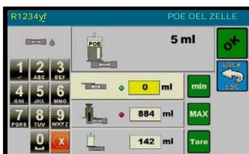
Den neuen Öl Behälter mit einer bekannten Menge an neuem Öl füllen (100 bis 250 cc gemessen auf den Behältermessanzeigen). Den Textkasten Max wählen, mit den Tasten 0 bis 9 den Wert der Menge eingeben; die MAX Taste drücken (der entsprechende Lichtpunkt wird grün werden):
