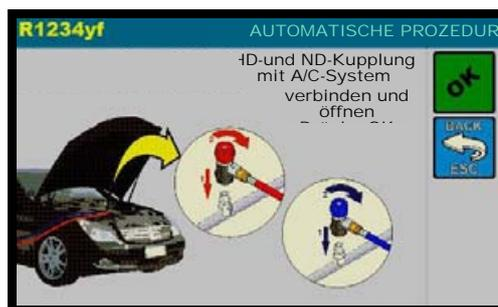
Die an das A/C System angeschlossene Kupplung (HD, ND oder HD/ND, abhängig von der vorigen Wahl) verbinden und öffnen, dann OK drücken, ZURÜCK drücken, um zurück zu gehen.
