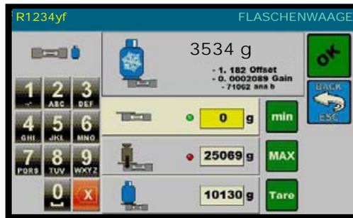
Das Bezugsgewicht (28 bis 30 kg) immer in die Mitte der Waagplatte legen. Den Textkasten Max wählen, mit den Tasten 0 bis 9 den Wert des Gewichtes eingeben; die MAX Taste drücken (der entsprechende Lichtpunkt wird grün werden):
