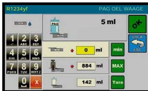
Den PAG Öl Behälter leeren. Den leeren Behälter in seiner Befestigung austauschen, dabei darauf achten, keinen Druck auf die Waage auszuüben, überprüfen, ob der Wert in dem Textkasten Min 0 g ist (andernfalls die Tastatur verwenden), dann die Min. Taste drücken (der entsprechende Lichtpunkt wird grün werden):
