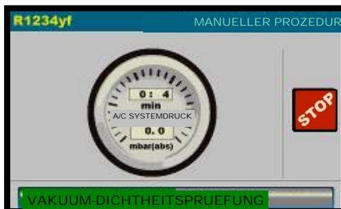
(WARNUNG! Wenn die Vakuumzeit weniger als die 15 min, wird dieser Test vertrauenswürdig). Wenn Lecks gefunden werden, stoppt die Maschine automatisch und der A/C SYSTEMLECK Alarm erscheint.
