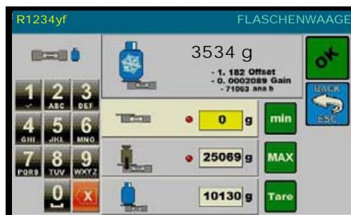
Mit der von der Waagplatte angehobenen Flasche, überprüfen, dass der Wert in dem Textkasten 0 g ist (andernfalls die Tastatur verwenden), dann die Min. Taste drücken (der entsprechende Lichtpunkt wird grün werden):
