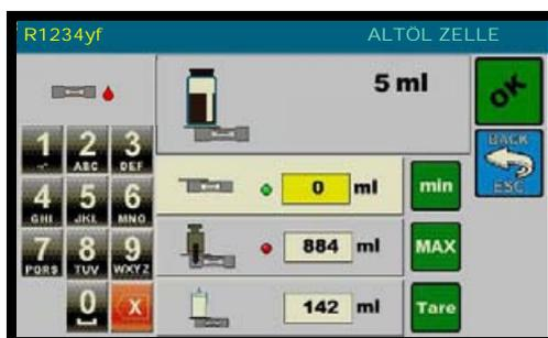
Den ALTÖL Behälter mit einer bekannten Menge an Öl füllen (100 bis 250 cc gemessen auf den Behältermessanzeigen). Den Textkasten Max wählen, mit den Tasten 0 bis 9 den Wert der Menge eingeben; die MAX Taste drücken (der entsprechende Lichtpunkt wird grün werden):
