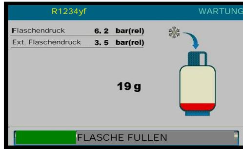
Die Maschine startet mit der Füllung mit der voreingestellten Menge ~ 500g. Wenn die Menge unter 500 Gramm erreicht ist, stoppt die Maschine und zeigt
