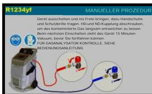
Gerät ausschalten und ins Freie bringen, dazu Handschuhe und Schutzbrille tragen. HD-und ND-Kupplung abschrauben, um das kontaminierte Gas langsam entweichen zu lassen.
