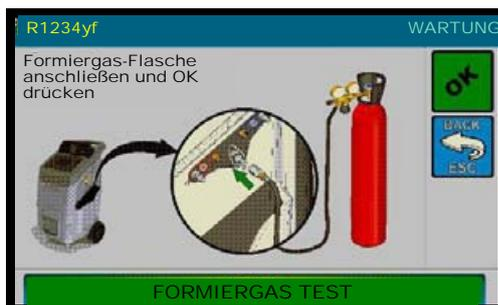
Formiergas Flasche (N<sub>2</sub>+H<sub>2</sub>) anschließen und OK drücken:
