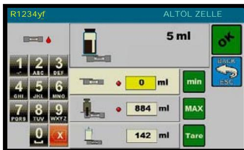
Den ALTÖL Behälter leeren. Den leeren Behälter in seiner Befestigung austauschen, dabei darauf achten, keinen Druck auf die Waage auszuüben, überprüfen, ob der Wert in dem Textkasten Min 0 g ist (andernfalls die Tastatur verwenden), dann die Min. Taste drücken (der entsprechende Lichtpunkt wird grün werden):
