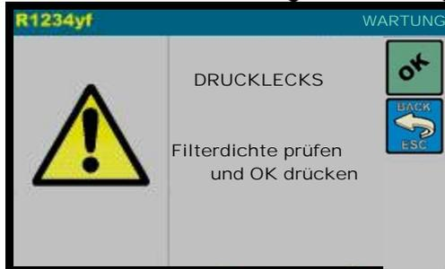
Filterdichte überprüfen und OK drücken, um die Druckkontrolle erneut zu starten.
