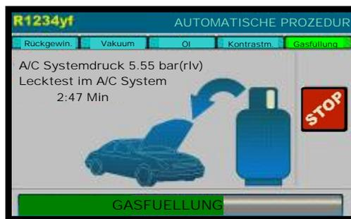
Wenn Lecks gefunden werden, gibt die Maschine eine akustische Alarmmeldung, andernfalls fährt die Maschine mit der Behüllung mit der voreingestellten Kältemittelmenge fort.
