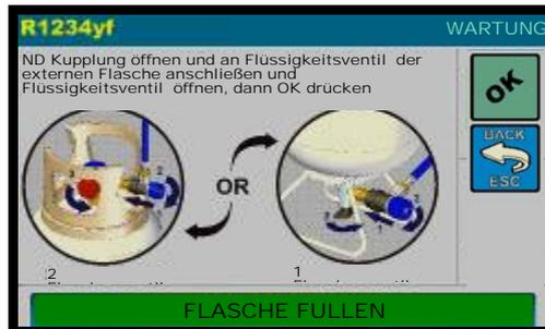
Eine Flasche mit R1234yf Kältemittel beschaffen, ND-Kupplung an Flüssigkeitsventil der externen Flasche anschließen und öffnen, dann OK drücken.
