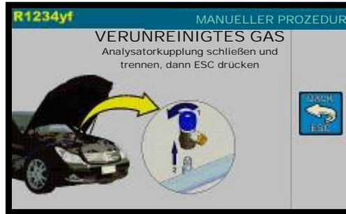
Analysatorkupplung schließen und trennen, dann ESC drücken
