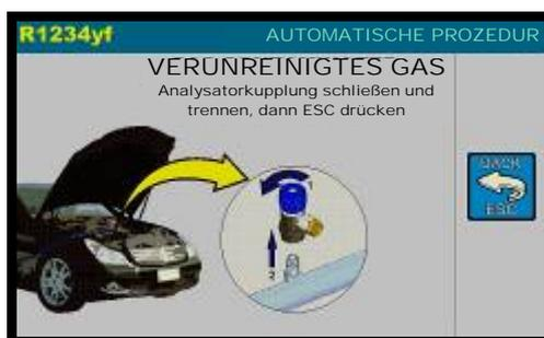
Analysatorkupplung schließen und trennen, dann ESC drücken
