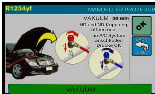
Die an das A/C System angeschlossene Kupplung verbinden und öffnen, dann OK drücken, ZURÜCK drücken, um zurückzukehren.
