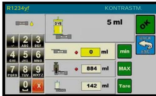
Den KONTRASTM. Behälter leeren. Den leeren Behälter in seiner Befestigung austauschen, dabei darauf achten, keinen Druck auf die Waage auszuüben, überprüfen, ob der Wert in dem Textkasten Min 0 g ist (andernfalls die Tastatur verwenden), dann die Min. Taste drücken (der entsprechende Lichtpunkt wird grün werden):
