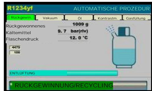
Wenn die Maschine den Vorgang vollständig beendet, wird das Risiko von Rückflüssen, welches die erneute Ladung von übermäßigem nicht kondensierbarem Gas in der Klimaanlage, reduziert. Wenn Rückstände von Kältemittel in dem A/C System im Druck erhöht werden während dieser Phase, startet die Maschine automatisch die Kältemittel-Rückgewinnung.
