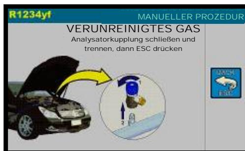
Analysatorkupplung schließen und trennen, dann ESC drücken
