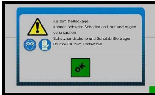
Kältemittelleckage können schwere Schäden an Haut und Augen verursachen, Schutzhandschuhe und Schutzbrille tragen. Drücke OK zum Fortsetzen.
