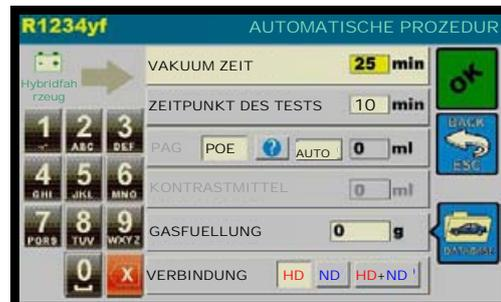
**ANMERKUNG:** Wenn HYBRIDFAHRZEUG ausgewählt ist, sind die PAG ÖL und KONTRASTM. Phasen des AUTOMATISCHEN PROZEDUR ausgeschaltet.
