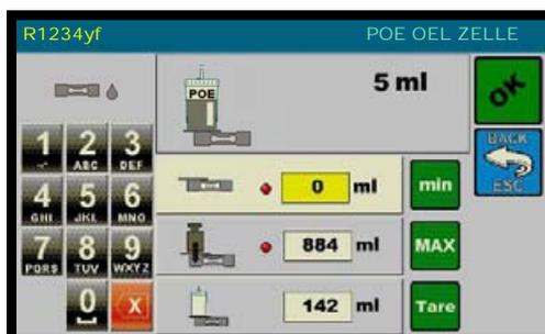
Den POE Öl Behälter leeren. Den leeren Behälter in seiner Befestigung austauschen, dabei darauf achten, keinen Druck auf die Waage auszuüben, überprüfen, ob der Wert in dem Textkasten Min 0 g ist (andernfalls die Tastatur verwenden), dann die Min. Taste drücken (der entsprechende Lichtpunkt wird grün werden):
