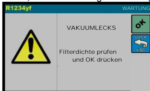
Filterdichte überprüfen und OK drücken um die Vakuumkontrolle erneut zu starten.
