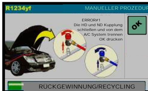
Die HD und ND Kupplung schließen und von dem A/C System trennen, dann OK drücken um fortzufahren.
