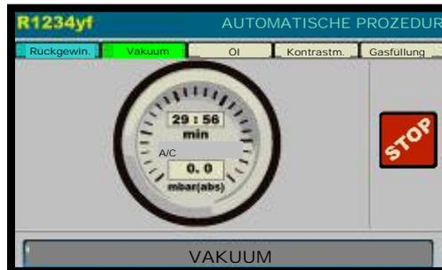
am Ende dieser Phase, testet die Maschine auf Lecks im A/C System :
