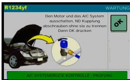
Den Motor und das A/C System ausschalten, ND Kupplung abschrauben ohne sie zu trennen, dann OK drücken:
