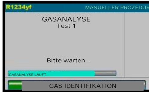
Falls das Kältemittel in dem A/C System nicht die geforderten Reinheitsstandards erfüllt, führt die Maschine einen zweiten und dritten Test durch. Wenn alle drei Tests fehlschlagen:
