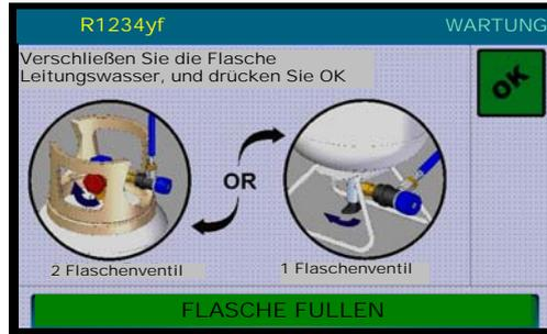
Verschließen Sie die Flasche Leitungswasser, und drücken Sie OK, wird die Maschine die restliche Kältemittel aus den Schläuchen zu erholen, dann den folgenden Bildschirm anzuzeigen:
