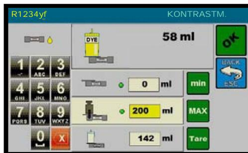
Das richtige Ablesen der Waage überprüfen und verschiedene Bezugsgewichte dazugeben und entfernen (100g entsprechen 104 ml). Den Textkasten Leergewicht wählen, mit den Tasten 0 bis 9 den Wert des Leergewichts eingeben (normalerweise ungefähr 150g); dann die Leergewicht Taste drücken, um zu bestätigen.
