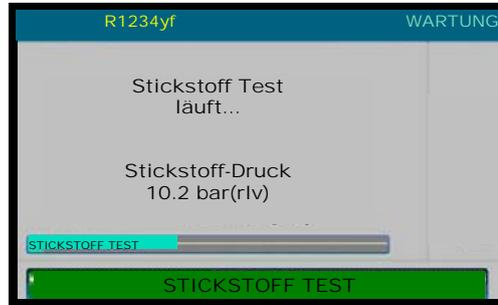
Wenn Lecks gefunden werden, gibt die Maschine ein Alarmsignal, der Stickstoff wird aus dem System abgelassen und die SYSTEMLECKS Alarmmeldung erscheint. Wenn das Test keine Lecks entdeckt, lässt die Maschine den Stickstoff ab:
