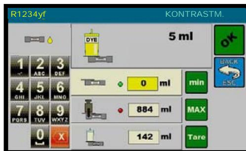
Den KONTRASTM. Behälter mit einer bekannten Menge an KONTRASTM. füllen (100 bis 250 cc gemessen an den Behältermessanzeigen). Den Textkasten Max wählen, mit den Tasten 0 bis 9 den Wert der Menge eingeben; die MAX Taste drücken (der entsprechende Lichtpunkt wird grün werden):
