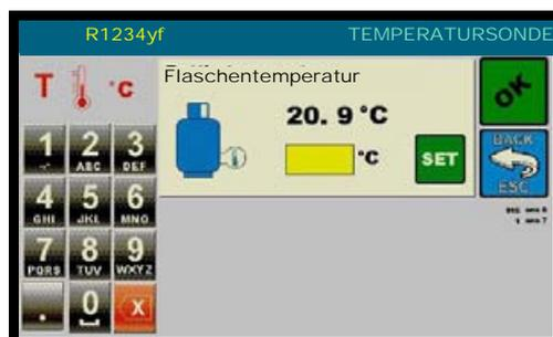
Überprüfen, ob die Temperatur auf der Anzeige dieselbe ist, wie die auf dem externen Thermometer. Wenn notwendig, den Bezug-Textkasten wählen, mit den Tasten 0 bis 9 den Wert des externen Thermometers eingeben dann EINSTELLUNG drücken, um zu bestätigen.
