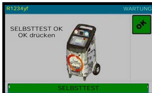
**ANMERKUNG:** Selbstdiagnose ist nur gültig, wenn die Maschine nicht an das A/C System angeschlossen ist, aber die Schläuche, vollständig mit Schnellanschlusskupplungen an die Maschine.
