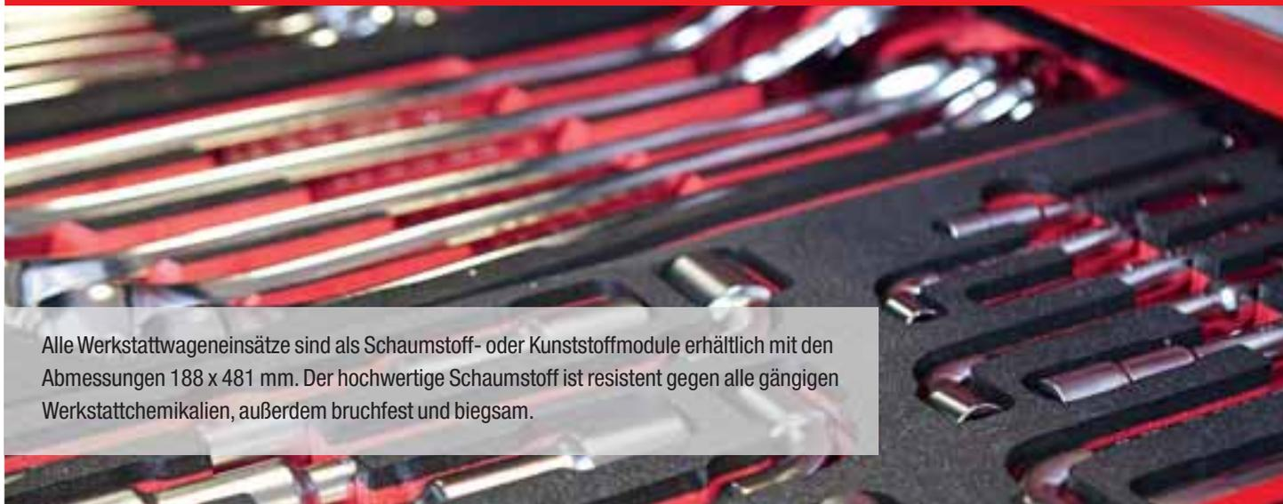
Alle Werkstattwageneinsätze sind als Schaumstoff- oder Kunststoffmodule erhältlich mit den Abmessungen 188 x 481 mm. Der hochwertige Schaumstoff ist resistent gegen alle gängigen Werkstattchemikalien, außerdem bruchfest und biegsam.
